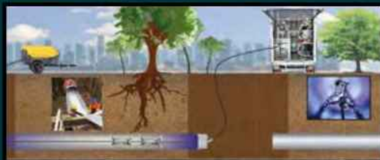
安裝套管並以紫外綫 (UV Liner) 將之固化 (Curing)
