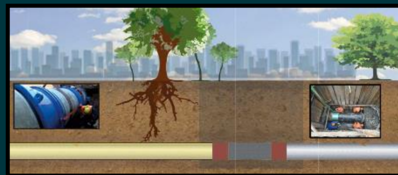
安裝新短管並恢復加壓污水管 (Rising Main) 的運作
